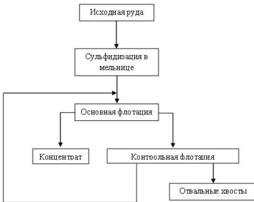
Рис .2. Лабораторная схема переработки окисленных медных руд Техутского месторождения РА
