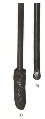
Рис. 1. Образцы дисилицида молибдена после выдержки их в жидком железе (а – 10 с, б – 50 с)
