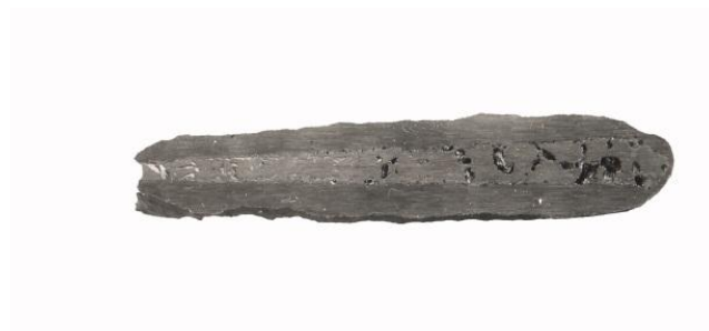
Рис. 3. Фотография разреза дисилицида молибдена после выдержки в жидком железе в течение 5 с
