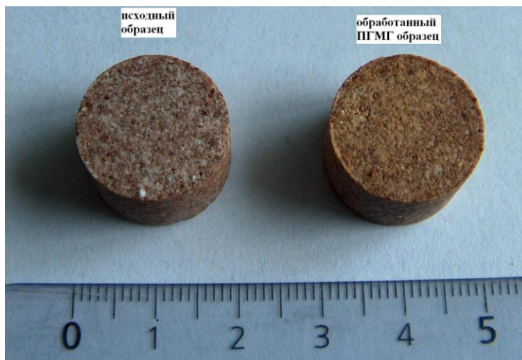
Рис. Фотографии образцов сорбционно-фильтрующих материалов на основе клиноптиллолита Армении до и после обработки комплексным соединением на основе полигексаметилгуанидина (ПГМГ)
