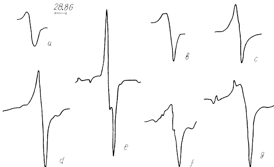
Рис. Спектры ЭПР продуктов превращения \text{CuSO}_4 в режиме ВЦР и при воздействии только углеводородными газами (пропан-бутановая смесь): а – исходный безводный \text{CuSO}_4 ; б – кристаллогидрат \text{CuSO}_4 \cdot n\text{H}_2\text{O} ; в – воздействие только углеводородом (RH) при 373 °С (Cu – 0, \text{Cu}_2\text{O} – 4, CuO – 0, 2\text{CuCO}_3 \cdot \text{Cu}(\text{OH})_2 – 6, \text{CuSO}_4 – 90%), кристаллизация – 20%; д – воздействие цепной реакцией при \text{RH}:\text{O}_2 = 1,75:1 и 339 °С (Cu – 0, \text{Cu}_2\text{O} – 8, CuO – 0, 2\text{CuCO}_3 \cdot \text{Cu}(\text{OH})_2 – 40, \text{CuSO}_4 ~ 50 %), кристаллизация – 25 %; е – воздействие только углеводородом (RH) при 400 °С (Cu – 0, \text{Cu}_2\text{O} – 8, CuO – 0, 2\text{CuCO}_3 \cdot \text{Cu}(\text{OH})_2 – 20, \text{CuSO}_4 – 72 %), кристаллизация – 20 %; ф – воздействие цепной реакцией при \text{RH}:\text{O}_2 = 1,75:1 и 403 °С (Cu – 0, \text{Cu}_2\text{O} – 70, CuO – 0, 2\text{CuCO}_3 \cdot \text{Cu}(\text{OH})_2 – 0, \text{CuSO}_4 – 30 %), кристаллизация – 50 %; г – воздействие цепной реакцией при \text{RH}:\text{O}_2 = 1,75:1 и 369 °С (Cu – следы, \text{Cu}_2\text{O} – 55,8, CuO – 0, 2\text{CuCO}_3 \cdot \text{Cu}(\text{OH})_2 – 0, \text{CuSO}_4 – 37 %), кристаллизация – 25 %.
